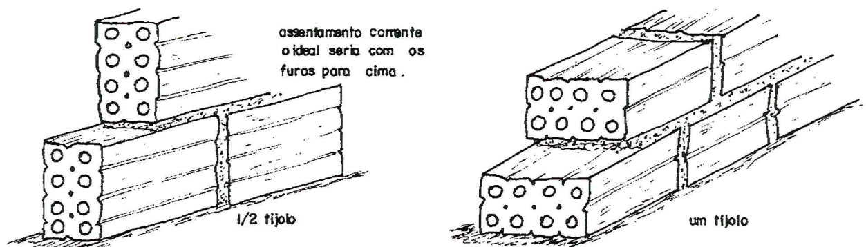
Figura 1 - Execução de alvenaria utilizando tijolos furados.
