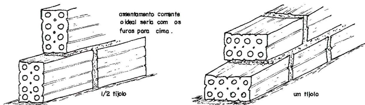
Figura 1 - Execução de alvenaria utilizando tijolos furados.
