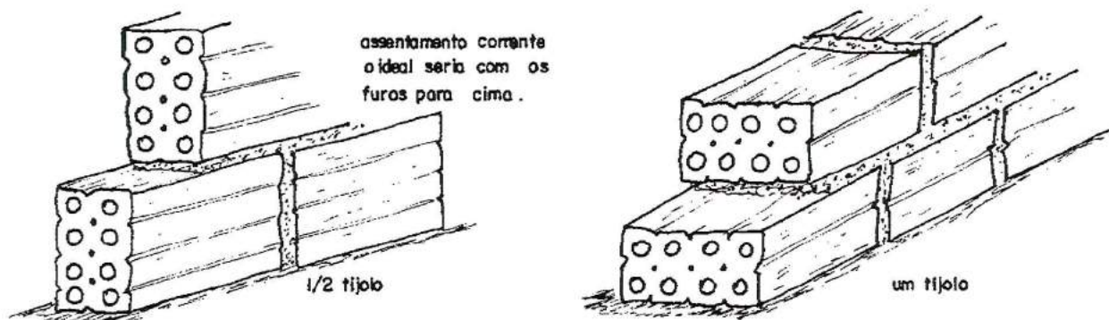
Figura 1 - Execução de alvenaria utilizando tijolos furados.
