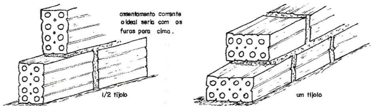
Figura 1 - Execução de alvenaria utilizando tijolos furados.
