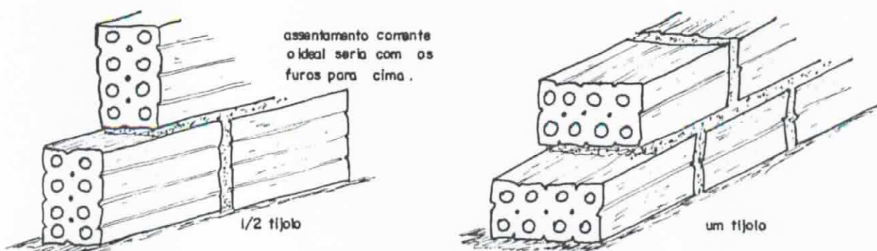
Figura 1 - Execução de alvenaria utilizando tijolos furados.
