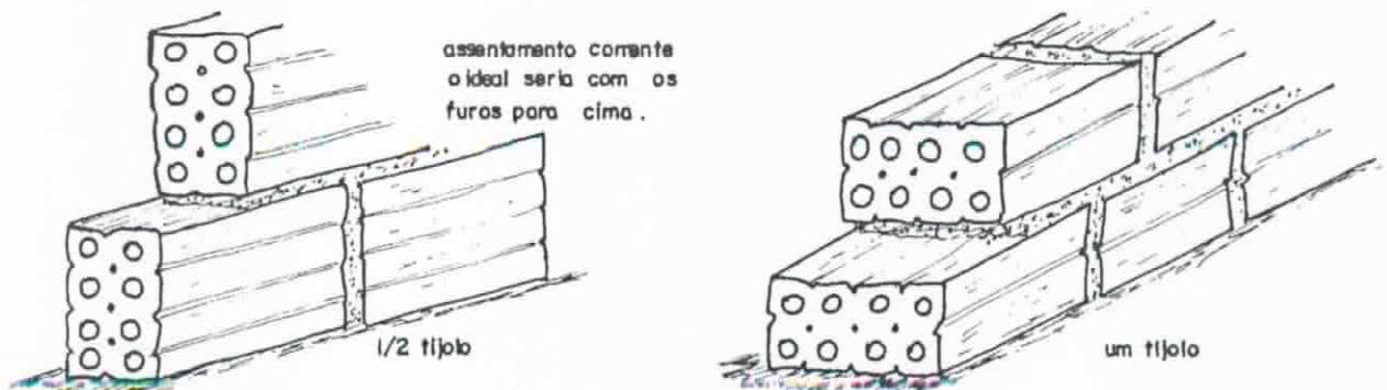
Figura 1 - Execução de alvenaria utilizando tijolos furados.
