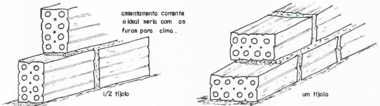
Figura 1 - Execução de alvenaria utilizando tijolos furados.
